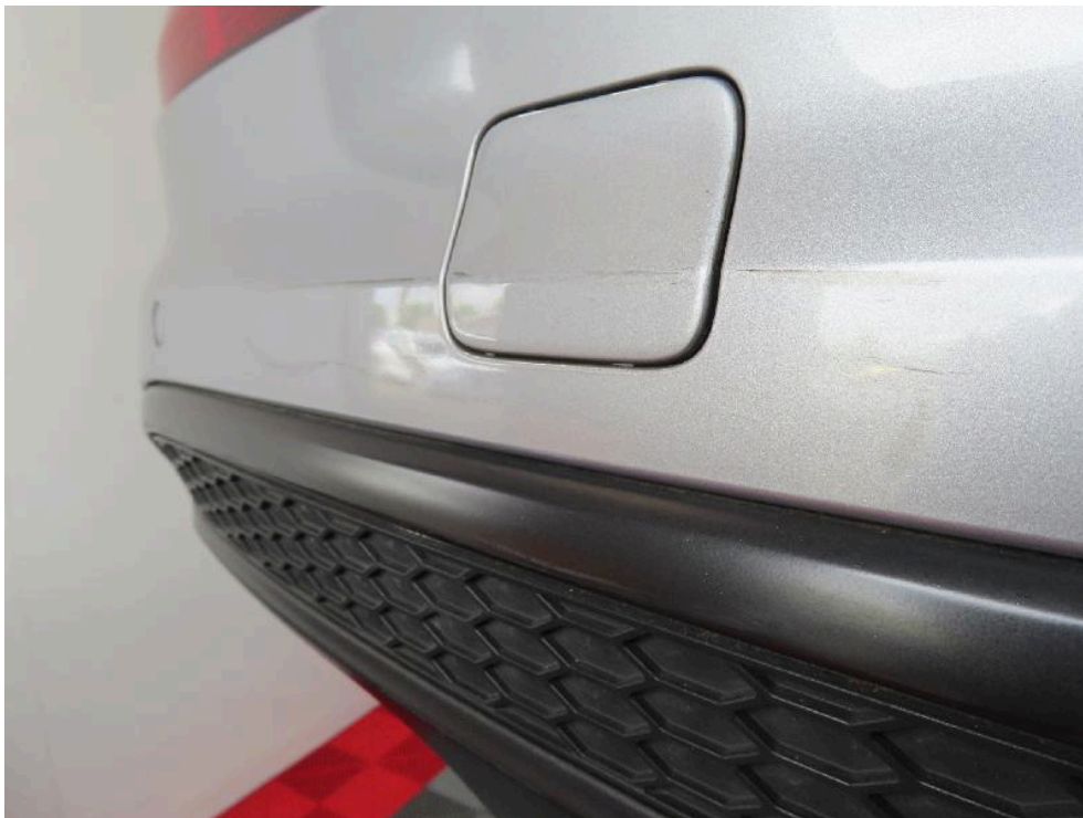
Bild: 15 Kratzer Stoßstange hinten links
