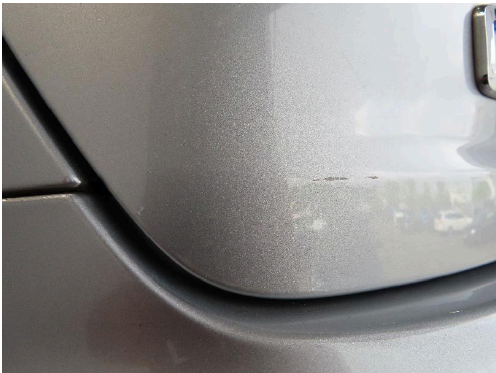
Bild: 18 Kratzer Heckklappe hinten links
