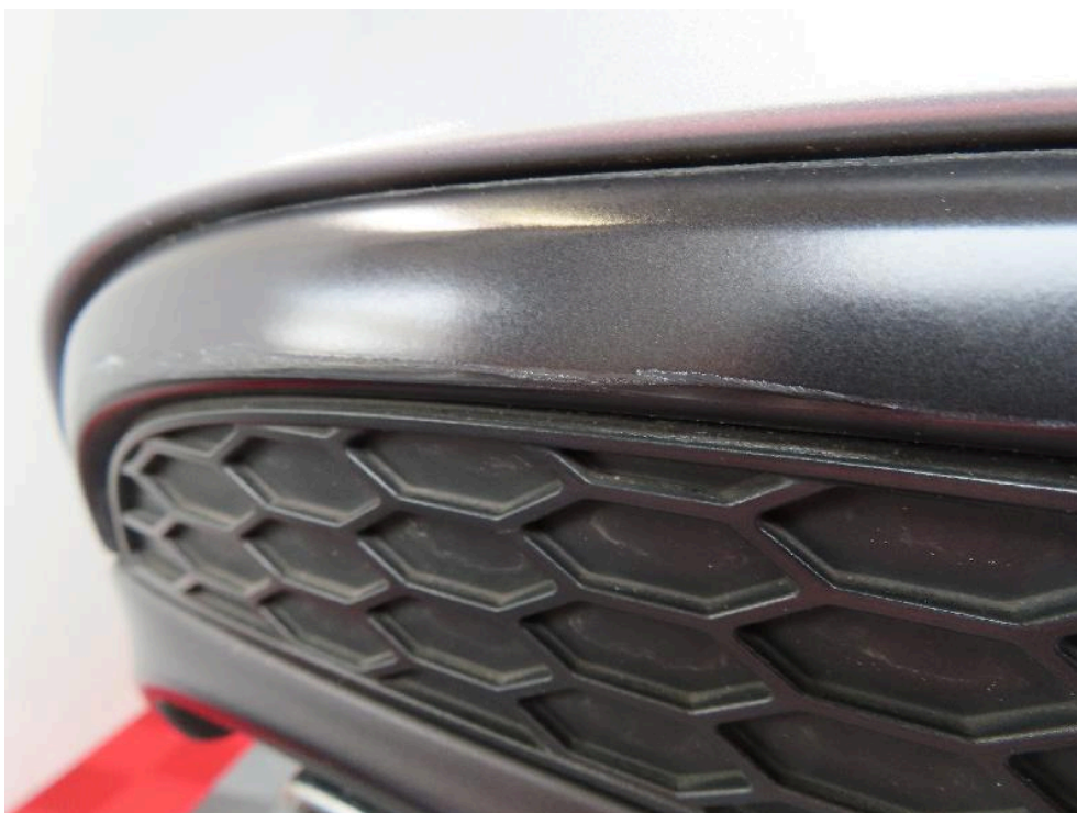
Bild: 16 Kratzer Stoßstange hinten links
