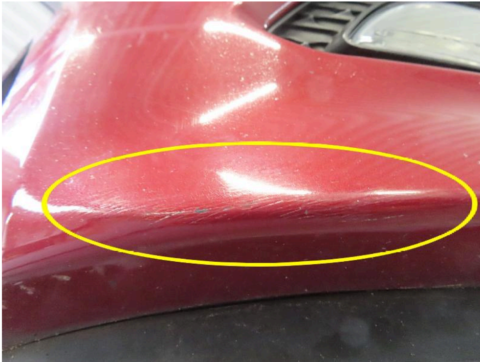
Bild: 15 Kratzer Stoßstange vorn rechts unterhalb
